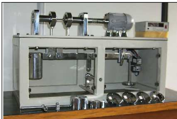
Figura 2 - Máquina de Fadiga Flexo-Rotativa aberta no Laboratório de Análise Estrutural da Pontifícia Universidade Católica de Minas Gerais
